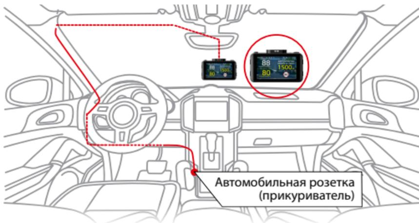
**Важно!** В случае комплектации автомобиля атермальным (с инфракрасным фильтром) лобовым стеклом и/или обогревом лобового стекла возможна задержка поиска GPS-сигнала и погрешность в определении текущей скорости и других GPS-параметров.
