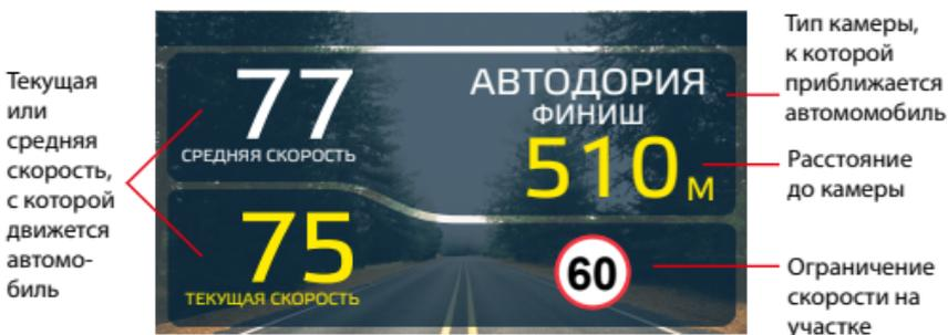
Если функция **SMART Определение GPS-точек** выключена, то расстояние, в пределах которого будет происходить оповещение по GPS-базе камер, необходимо выставить также вручную. Для этого в меню устройства предусмотрена функция **Расстояние определения точек GPS**.
