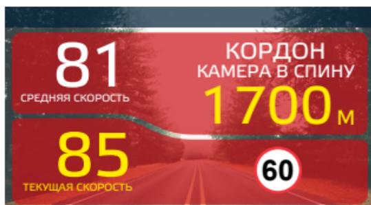
Показание дисплея, если перед малоомощной камерой (Кордон, Одиссей, Робот, Кречет, Mesta, Поток) текущая скорость превысит максимальную разрешенную скорость на участке.
